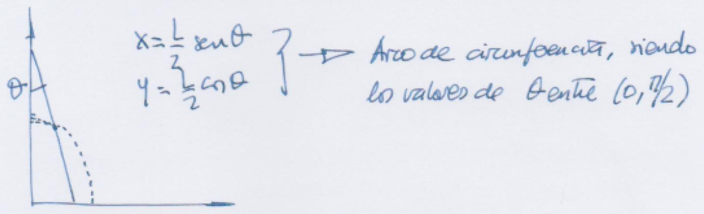
Para conocer el valor de la velocidad del centro de masas, se aplica el principio de conservación de la energía mecánica:
