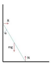
Estamos ante un claro problema de dinámica del sólido rígido: Dinámica porque el palo es deslizante (hay movimiento) y sólido rígido porque el palo es en principio indeformable.
